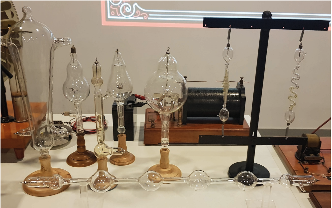
De izquierda a derecha: carrete de Ruhmkorff, tubos geissler y crookes
