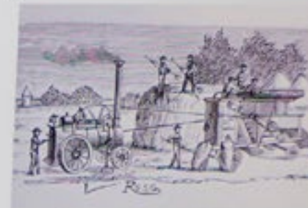
Trilladora mecánica asistida por un locomóvil. Talleres Tomás Trigueros, Málaga, 1908.
