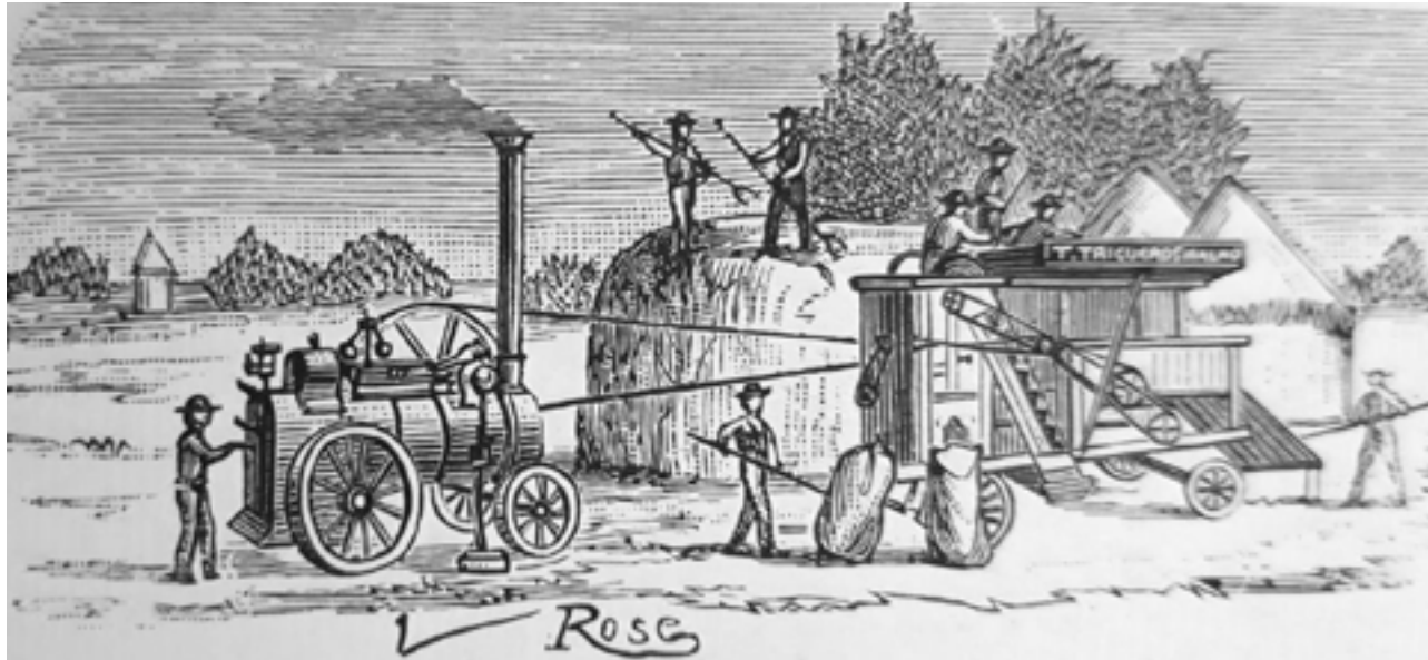
Trilladora mecánica asistida por un locomóvil, Catálogo de Tomás Trigueros, 1908.
